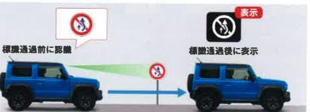
走行中に、単眼カメラが認識した“最高速度”、“はみ出し通行禁止”的標識をメーター内に表示させ、ドライバーにお知らせします。
