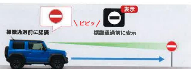
走行中に、単眼カメラが認識した“車両進入禁止”的標識を標識通過前にブザー音とメーター内表示で、ドライバーにお知らせします。
