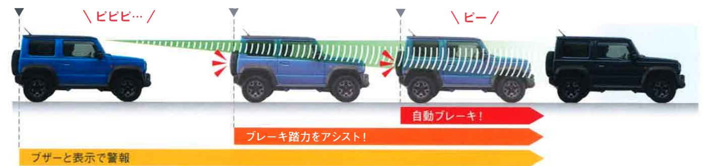
**!** 作動した時の速度が約5km/h～約50km/h未満(歩行者の場合は約5km/h～約30km/h未満)であれば、衝突回避できる場合があります。周囲の環境や対象物の動きなどによっては、警報のみでブレーキが作動しない場合があります。また、警報と同時に自動ブレーキが作動する場合があります。
