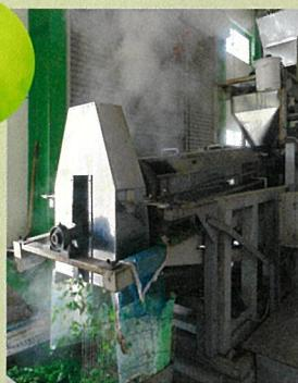
酸化酵素の働きを止め、茶葉の色を緑色に保たせるために、機械で蒸します。円筒形のドラムの中に入れられた茶葉は、蒸気にふれながら転がり、かき混ぜられ、まんべんなく蒸されています。蒸し時間の長さによって、味と香りの基本的な性格が決まる、大切な工程です。
