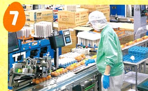
各サイズにパックされ、シール機械で封をします。パックされたたまごは出荷される時間まで、温度管理された製品庫で保管されます。
