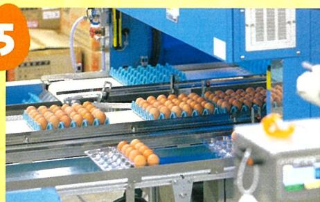
再度、人の肉眼で規格外のたまごを取り除き、さらに自動ひび卵検査装置を通して目では見えないキズのあるたまごを除去します。規格外のたまごが出ても廃棄ではなく、「液卵」用としてマヨネーズなどの原料として出荷されます。
