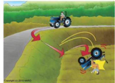
軽傷で済んだ理由：シートベルトをしていたので投げ出されておらず、安全フレームを立てていたため、完全に下敷きにならずに済んだ。
